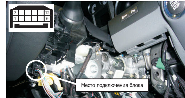
Рис. 4. (нумерация контактов в разъеме, вид со стороны проводов)
