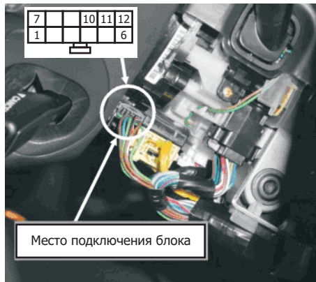
Рис.3. (нумерация контактов в разъеме, вид со стороны проводов).
